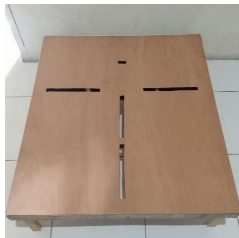
Gambar 9. Ruas Bangun Alat Pelipat Pakaian
