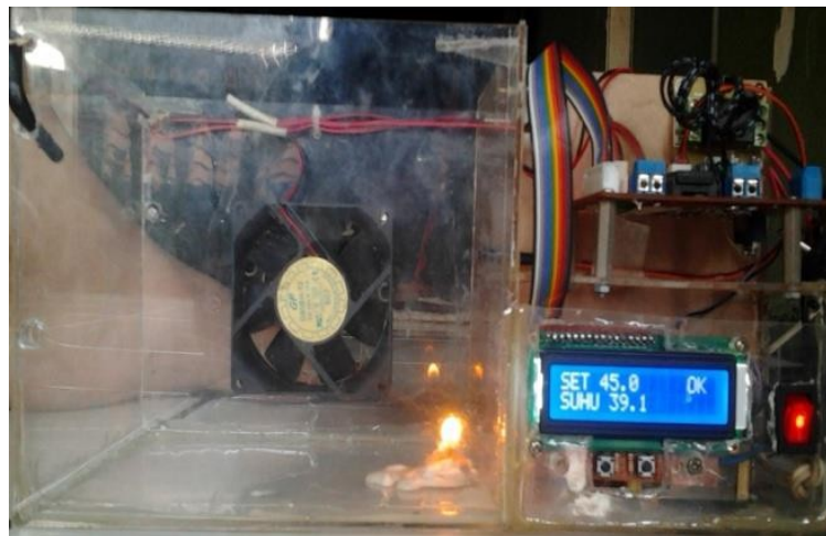
Gambar 13. Sensor suhu LM35DZ mendeteksi suhu melebihi setingan
