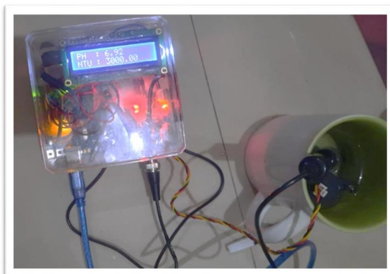
Gambar 5: Tes Kalibrasi Sensor pH
