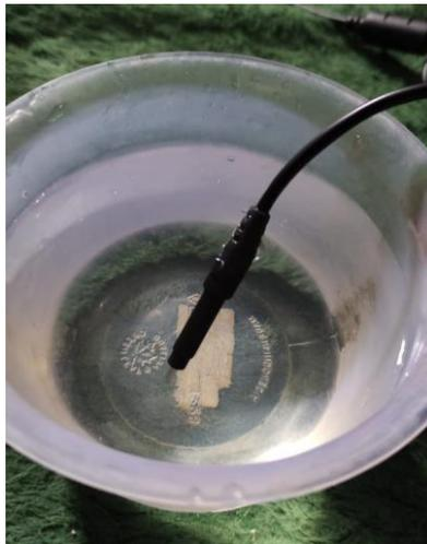
**Gambar 12.** Pengujian Sensor TDS Meter
