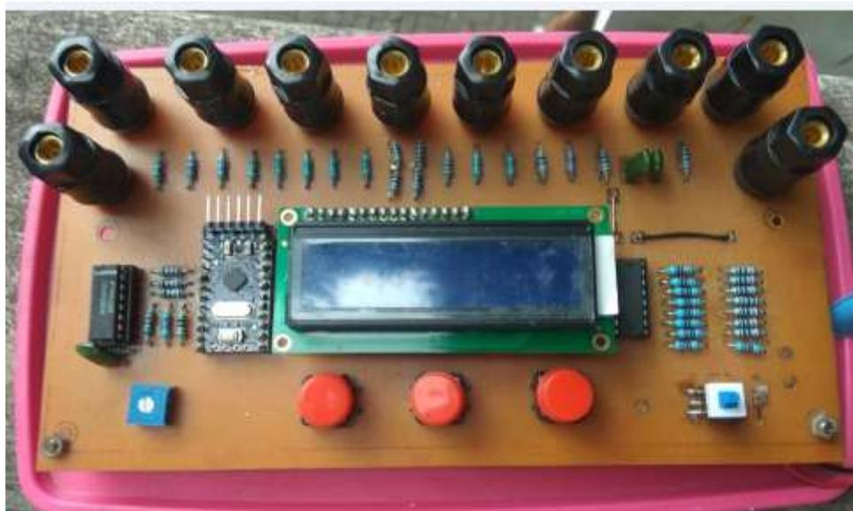
**Gambar 10. Hasil akhir alat ECG simulator yang diujikan**
