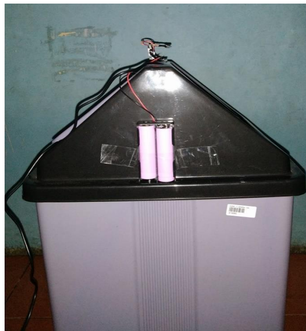
Gambar 9. Penempatan power supply pada tempat sampah
