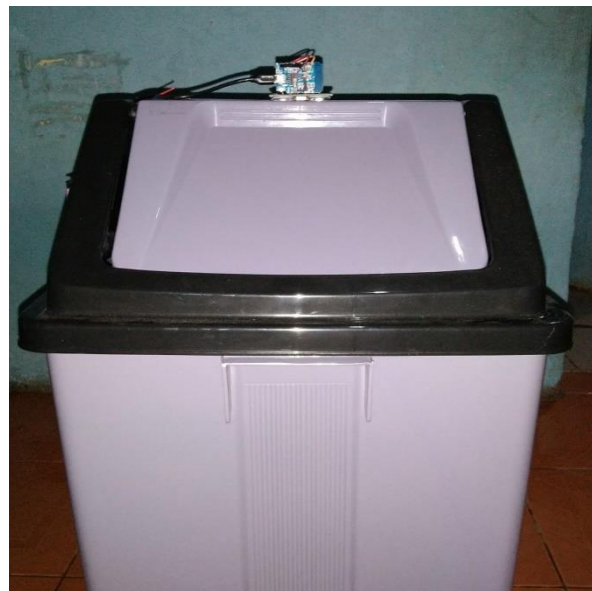
Gambar 8. Rangkaian lampu LED WeMos dan ultrasonik pada tempat sampah
