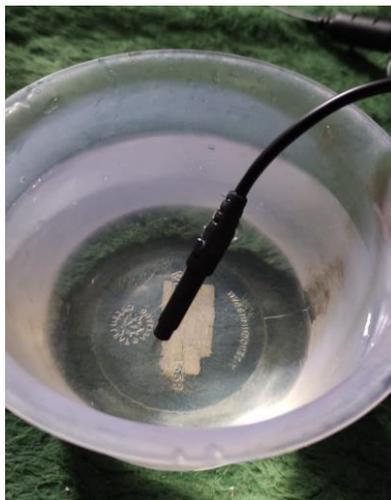
**Gambar 12.** Pengujian Sensor TDS Meter
