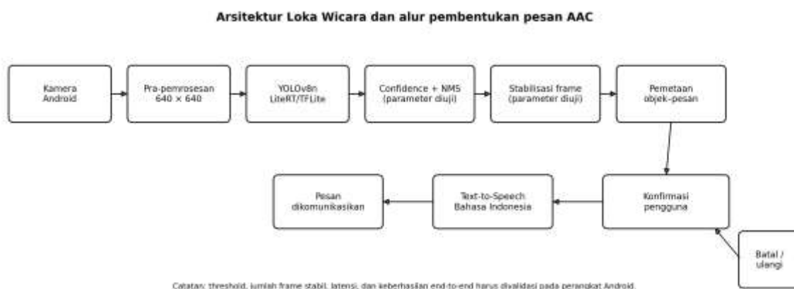
Gambar 1. Arsitektur Sistem dan Alur Pembentukan Pesan AAC
