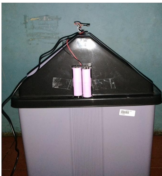
Gambar 6. Penempatan Power Supply
