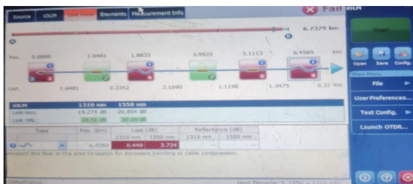
Gambar 9. Hasil Pengukuran jarak dengan Optical Time-Domain Reflectometer
