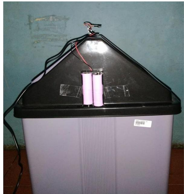
Gambar 9. Penempatan power supply pada tempat sampah
