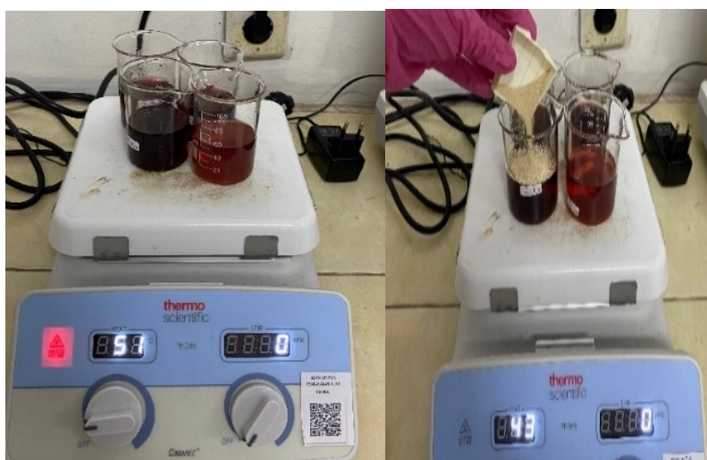
Gambar 2. Proses Liquifikasi (kiri) dan Proses Sakarifikasi (kanan)
