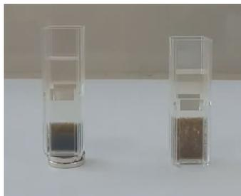
**Gambar 3. Pengendapan presipitat Fe(OH)<sub>2</sub> dengan magnet (kuvet kiri) dan tanpa bantuan magnet (kuvet kanan)**
