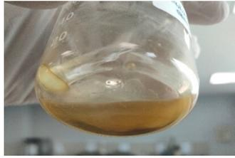
**Gambar 2. Presipitat FeS dan FeSO<sub>4</sub> hasil penambahan reagen Na<sub>2</sub>SO<sub>4</sub>**
