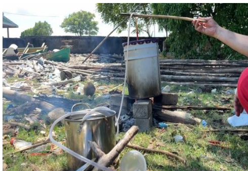
Gambar 3: Rangkaian Alat Pirolisis Sederhana Skala Kecil yang Didemonstrasikan kepada Peserta
